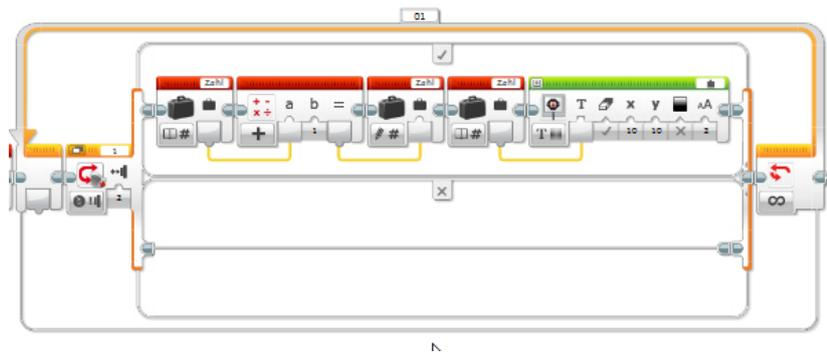
Weiter geht es mit dem Schalter-Block. Er hat folgende Aufgabe: Wenn der Drucksensor ausgelöst wird, soll etwas geschehen. Wenn der Drucksensor nicht ausgelöst wird, passiert nichts.
