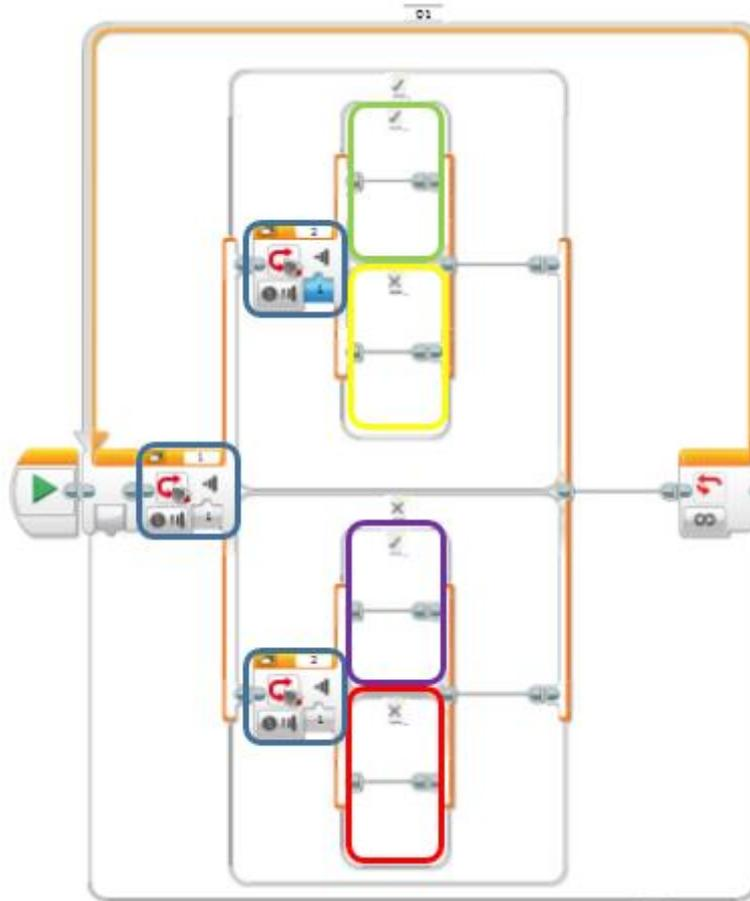
In den **blauen Bereichen** werden wiederum die Berührungssensoren definiert. Beachtet, dass der eine Sensor den Anschluss 1 hat, die anderen zwei den Anschluss 2. Dies muss so sein, immerhin haben wir ja zwei verschiedene Sensoren.
