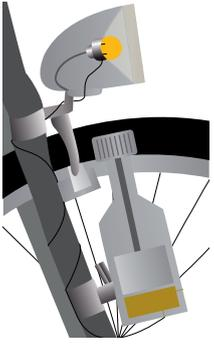
Ein Fahrraddynamo wandelt Bewegungsenergie in elektrische Energie um. Diese wird in der Glühbirne in sichtbare Strahlung und Wärme umgewandelt.
